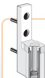
Bei der Höhenverstellung verdeckt der Buchsenkragen die Verstellspalte
